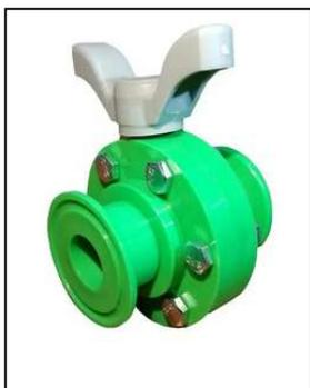
Opcional. Es una llave de paso plástica, tipo mariposa, con extremos clamp de 1 1/2" (50 mm) con sello de silicona y pasaje útil de 19 mm.
